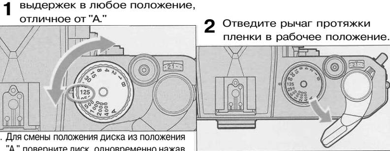
... Для смены положения диска из положения "A," поверните диск, одновременно нажав на кнопку фиксации.
